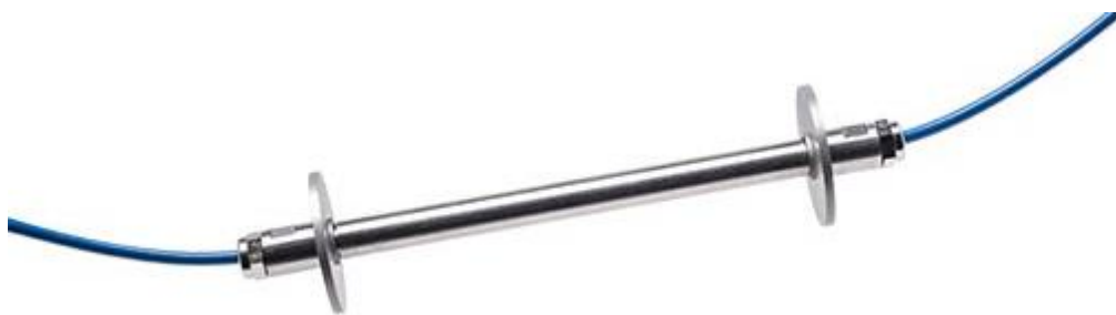
Figur 6: En typ av diskret fiberoptisk töjningsmätare. Från www.hbm.com .
