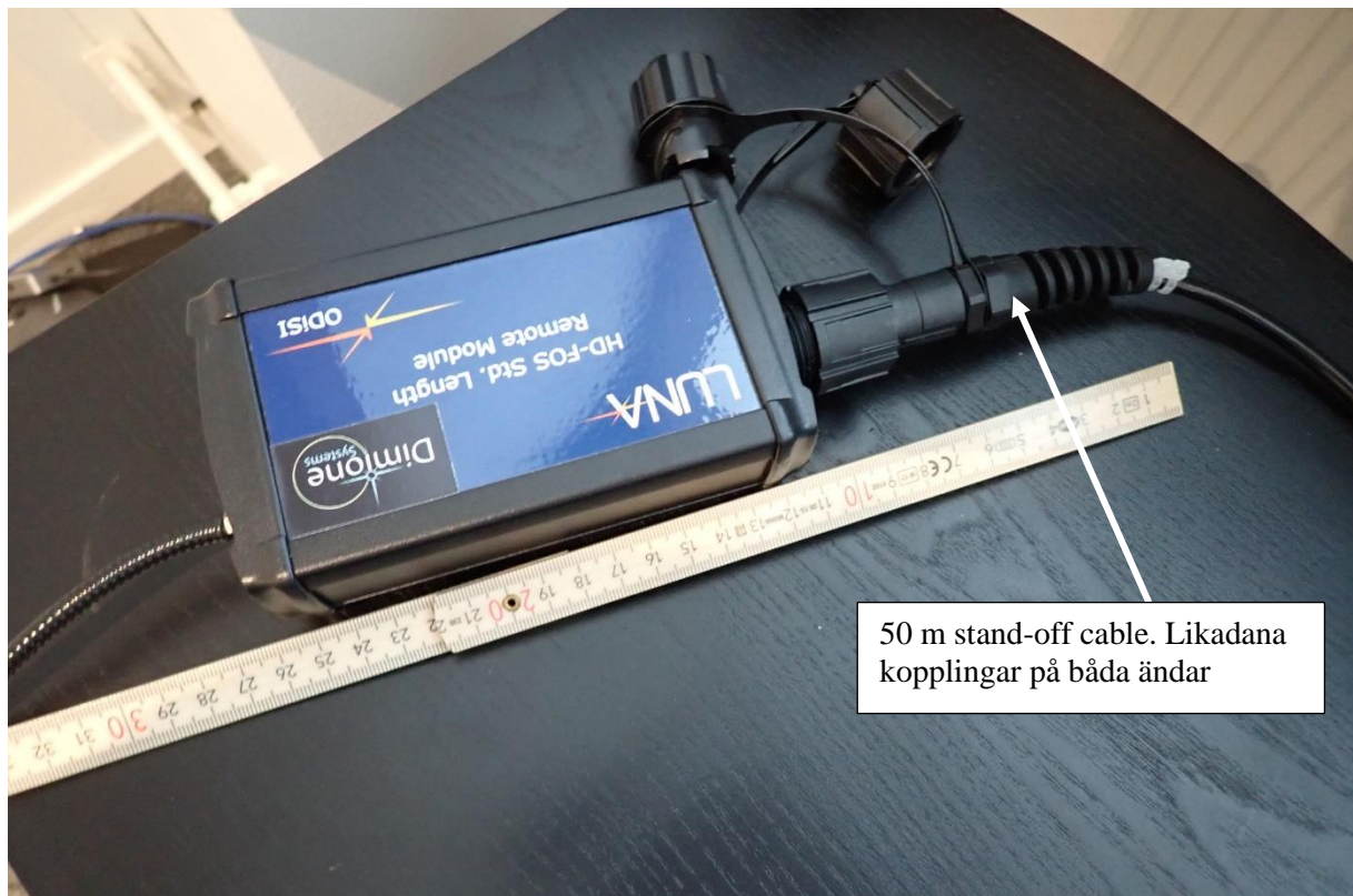
Figur 17: Remote module. Sitter mellan 50 m Stand-off cable. Dessa måste skyddas.
