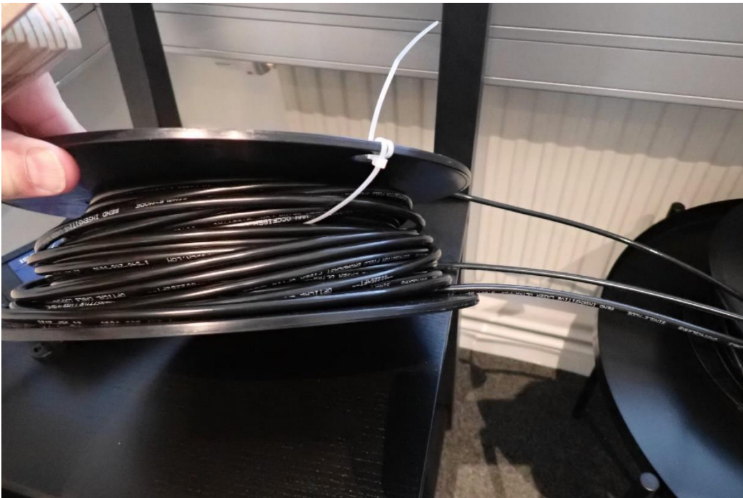
Figur 16: 50-m Stand-off cable på en rulle. För att koppla interrogatorn till fiberoptiken över en längre sträcka.
